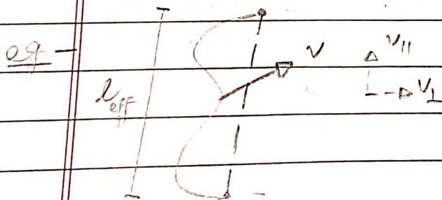
$$E = B l_{\perp} v_{\perp}$$
